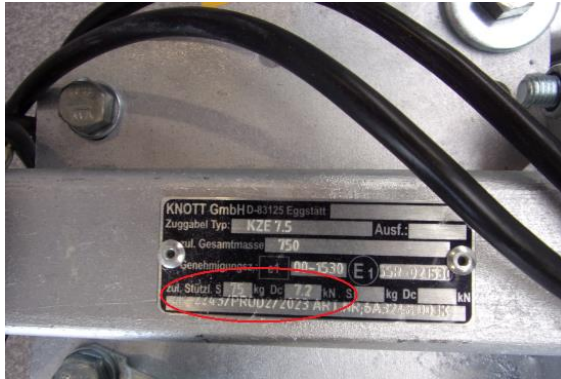
Foto 1. Platzierung auf dem Haken - maximaler Druck auf die Kupplungskugel.
