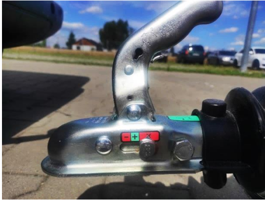
Foto 5. Die Kupplung ist geöffnet und der Hebel ist angehoben.
