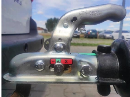
Foto 3. Anhängerkupplung ist geschlossen, Kupplungshebel abgesenkt.
