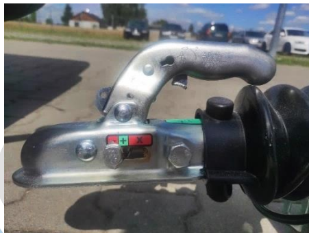
Foto 4. Die Anhängerkupplung ist geschlossen und der Hebel ist unten. Die Kupplungskugel oder die Kupplung ist abgenutzt. Sicheres Fahren ist nicht möglich.
