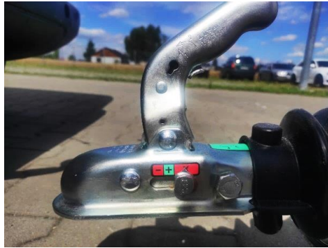
Photo 5. La tête d'attelage est ouverte, le levier de la tête d'attelage est relevé.
