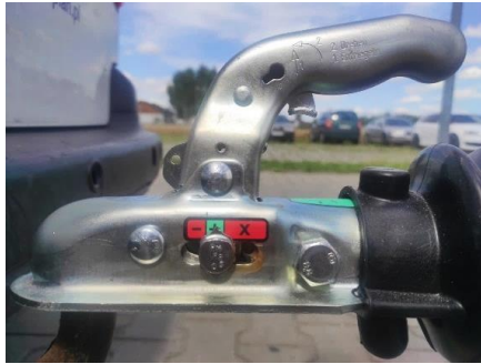
Photo 3. La tête d'attelage est bien fermée, le levier de la tête d'attelage est descendu.
