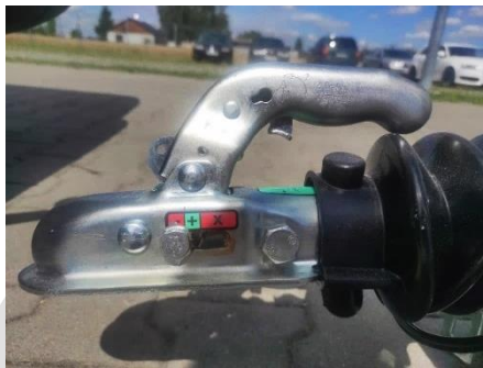
Photo 4. La tête d'attelage fermée, levier descendu. La boule du crochet ou la tête d'attelage est usagée. Il est impossible de rouler en sécurité.
