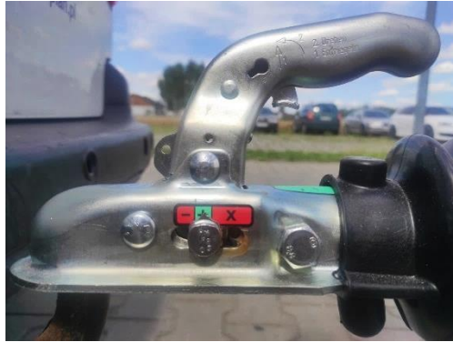
Fot. 3. Zacpek jest zamknięty, dźwignia zacpeku opuszczona.
