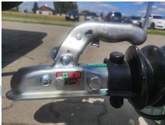
Fot. 4. Zacpek jest zamknięty, a dźwignia opuszczona. Kula haka bądź zacpek są zużyte. Bezpieczna jazda nie jest możliwa.
